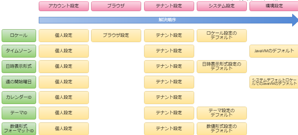
図 アカウントコンテキストの各プロパティの解決順序（一般ユーザ）
